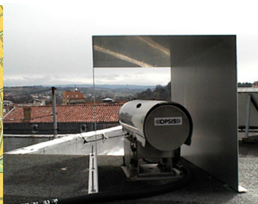
DOAS-mätning (bild från Castres i Frankrike)
