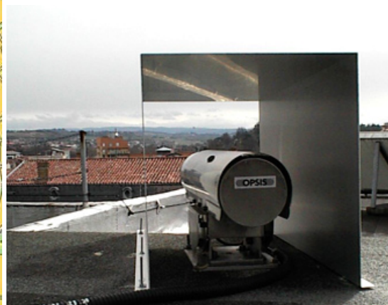
Exempel på DOAS-mätning (bild från Castres i Frankrike)
