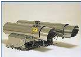
DOAS-utrustning: emittor och receptor
