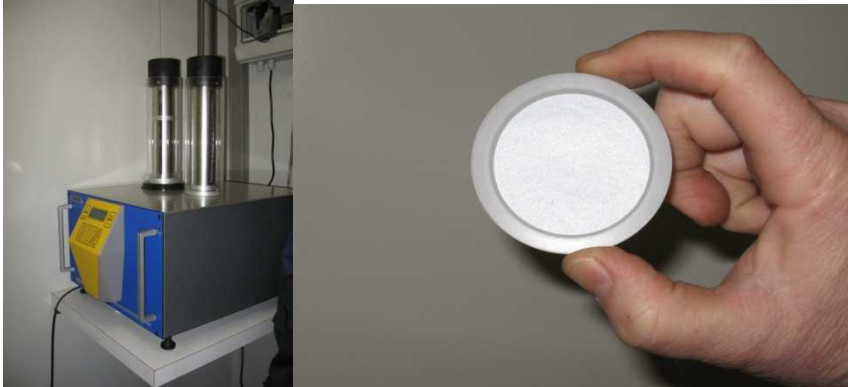
Mätinstrument SM200 med filterkassetter och filter
